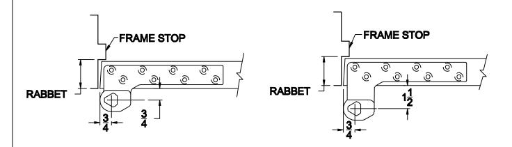
PIVOT POINT IS LOCATED 3/4" FROM THE HEEL EDGE OF DOOR.
