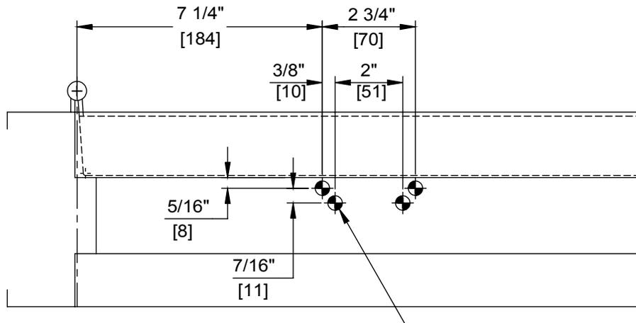
FOR 1/4-20 MACHINE SCREWS USE 7/32" DRILL
