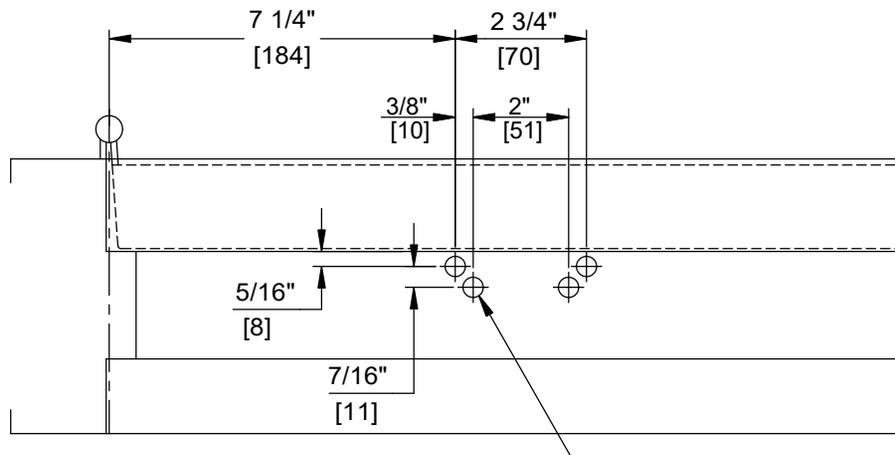
FOR 1/4-20 MACHINE SCREWS USE 7/32" DRILL
