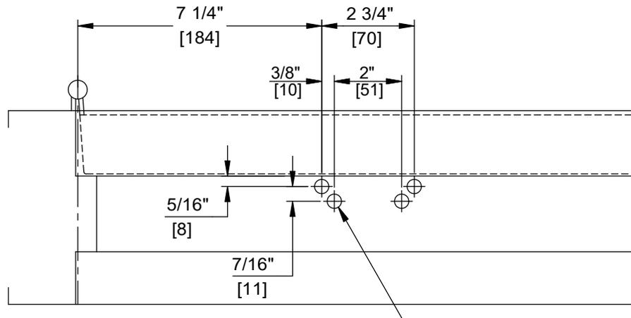
FOR 1/4-20 MACHINE SCREWS USE 7/32" DRILL
